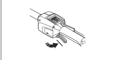
2. Drücken Sie die Gashebelsperre (A) nach vorne und nach unten. Drücken Sie die Gashebelsperre gegen den Griff (B), und stellen Sie sicher, dass sie in ihre ursprüngliche Position zurückgeht, wenn Sie sie loslassen.
