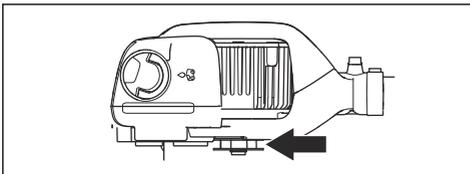
2. Ersetzen Sie das Kettenantriebsrad, wenn es abgenutzt ist und sich auf der Motorachse von einer zur anderen Seite bewegt.
