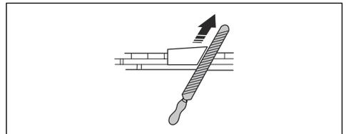
4. Entfernen Sie zuerst das Feilmaterial an allen Zähnen auf der einen Seite.
