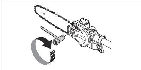
6. Stellen Sie sicher, dass sich die Sägekette leicht von Hand drehen lässt und nicht an der Führungsschiene herabhängt.
