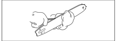
4. Überprüfen Sie die Nut in der Führungsschiene auf Verschleiß. Tauschen Sie die Führungsschiene aus wenn nötig.
