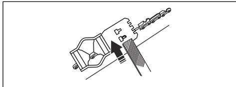
**Opomba:** Nastavitev globine reza je pravilna, ko pri premikanju pile po šablono za brušenje globinskih zob ne čutite upora.
