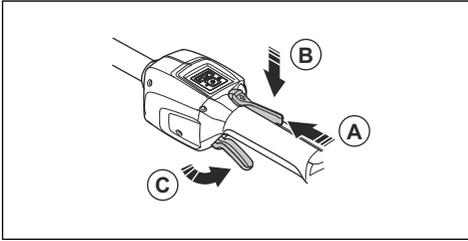
1. Kontrollieren Sie, ob der Gashebel gesperrt ist, wenn sich die Sperre in der Ausgangslage befindet.
