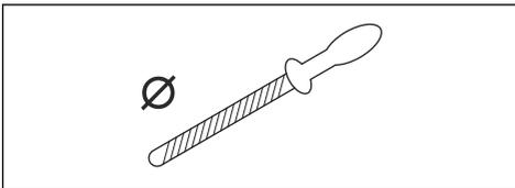
Ohne Hilfsmittel ist es nicht leicht, eine Sägekette korrekt zu schärfen. Verwenden Sie die empfohlene Schärflehre. Dies hilft Ihnen, die maximale Schneidleistung zu erhalten und die Rückschlaggefahr auf ein Minimum zu reduzieren.
