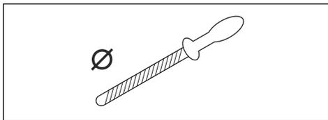
Verige ni enostavno pravilno nabrusiti brez ustrezne opreme. Uporabite priporočeno šablono za brušenje. Tako boste ohranili največjo učinkovitost rezanja in zmanjšali tveganje povratnega udarca.
